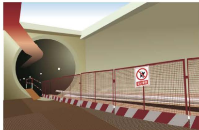
图 3.5.4-1 洞外轨行区防护
