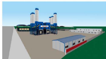
图 3.1.1-1 混凝土拌合站
