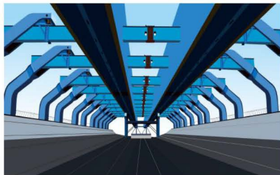
图 3.3.3-6 移动模架钢筋施工
