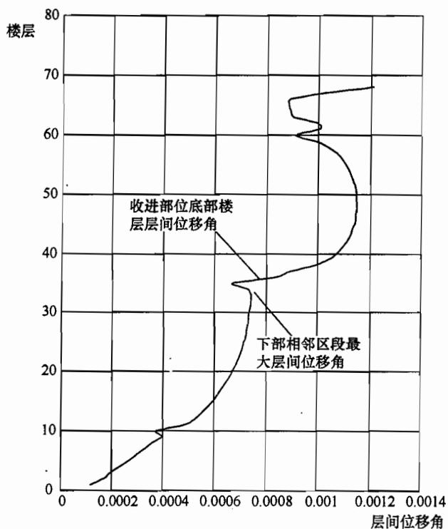
图 17 结构收进部位楼层层间位移角分布
