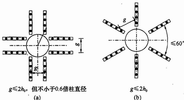
图10 圆柱周边抗剪栓钉排列示意
