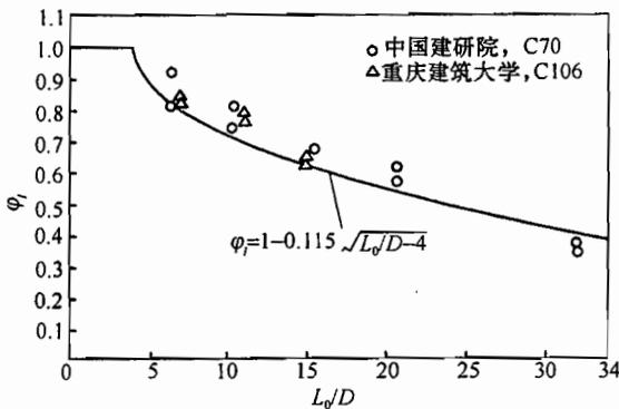
图 23 考虑长细比影响的折减系数试验值
