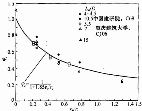
图 20 钢管高强混凝土柱折减系数  $\varphi_e$
