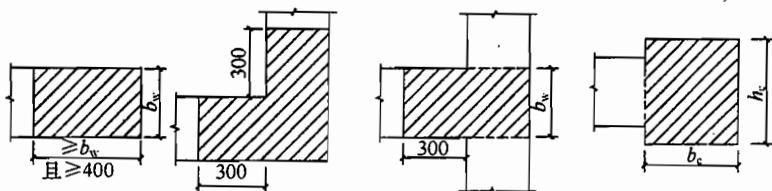
图 7.2.16 剪力墙的构造边缘构件范围
