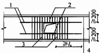
图 6.3.7 梁上洞口周边配筋构造示意
