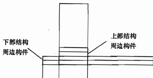
图 16 体型收进结构的加强部位示意
