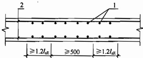
图 7.2.20 剪力墙分布钢筋的搭接连接
