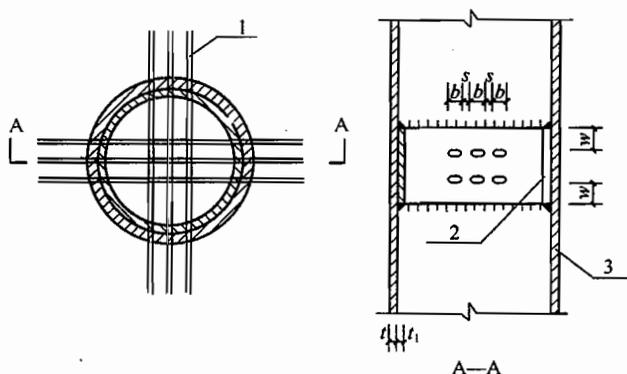
图 F. 2. 10 穿筋单梁构造示意
