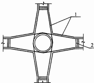
图 F. 2. 11 变宽度梁构造示意
