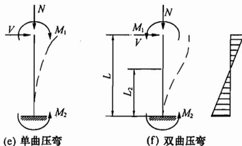
图 F.1.6 框架柱及悬臂柱计算简图
