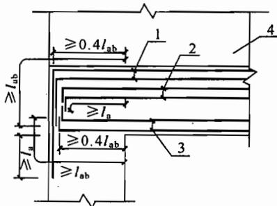
图 10.2.8 框支梁主筋和腰筋的锚固
