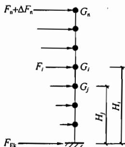
图 C 底部剪力法计算示意
