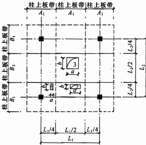
图 8.2.4 无梁楼板开洞要求
