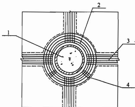
图 F.2.9 钢筋混凝土环梁构造示意
