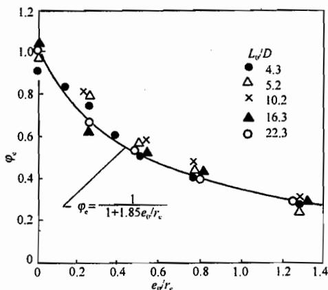
图 19 折减系数  $\varphi_e$  与偏心率的相关曲线
