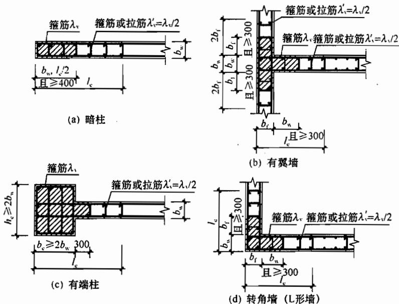
图 7.2.15 剪力墙的约束边缘构件
