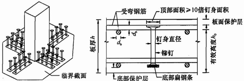
图 8 典型抗剪栓钉布置示意
