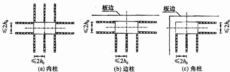
图9 矩形柱抗剪栓钉排列示意
