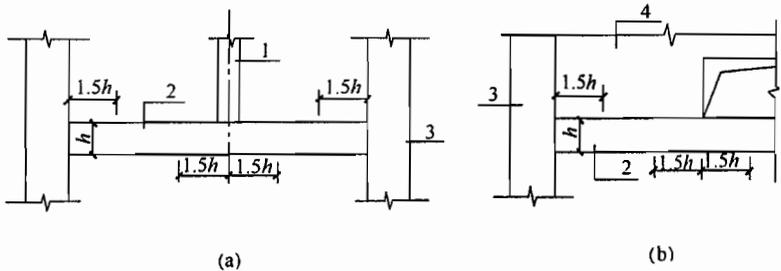
图 12 托柱转换梁、框支梁箍筋加密区示意
