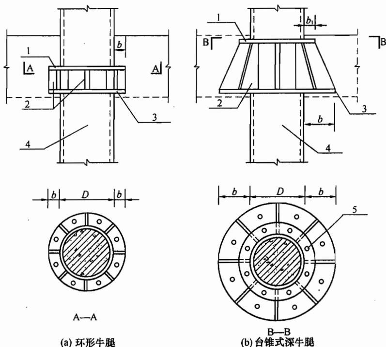
图 F. 2.5 环形牛腿构造示意
