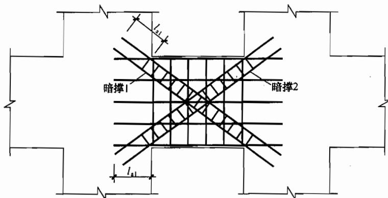
图 9.3.8 梁内交叉暗撑的配筋
