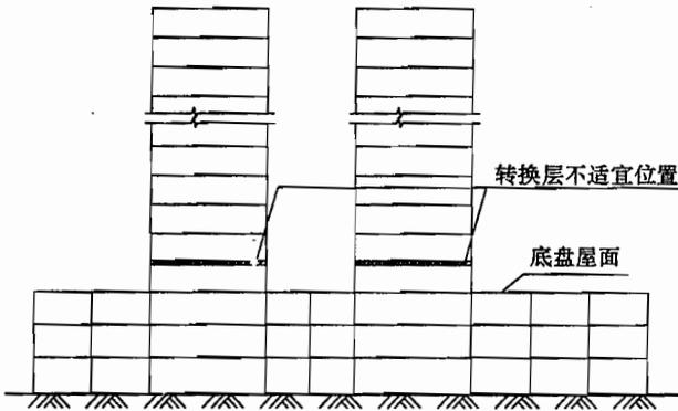
图 14 多塔楼结构转换层不适宜位置示意
