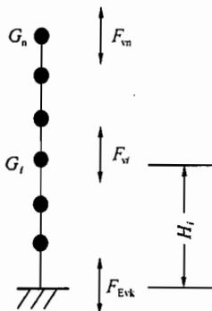
图 4.3.13 结构竖向地震作用计算示意
