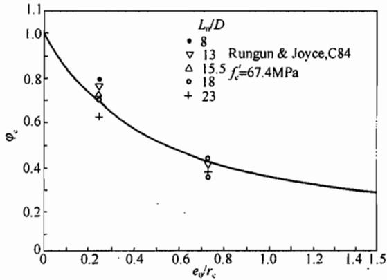
图 21 钢管高强混凝土柱折减系数  $\varphi_c$
