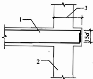
图 7.1.6 楼面梁伸出墙面形成梁头
