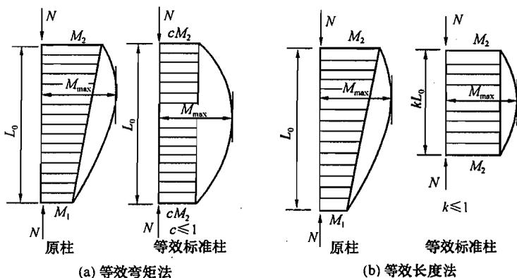
图 24 非标准单元柱的两种等效转换法
