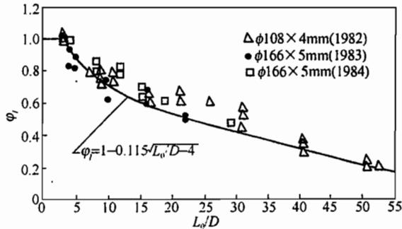
图 22 长细比对轴心受压柱承载能力的影响
