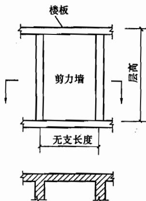
图7 剪力墙的层高与无支长度示意
