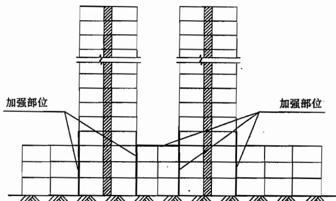
图 15 多塔楼结构加强部位示意
